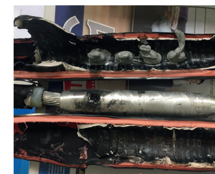
Danno giunto media tensione
